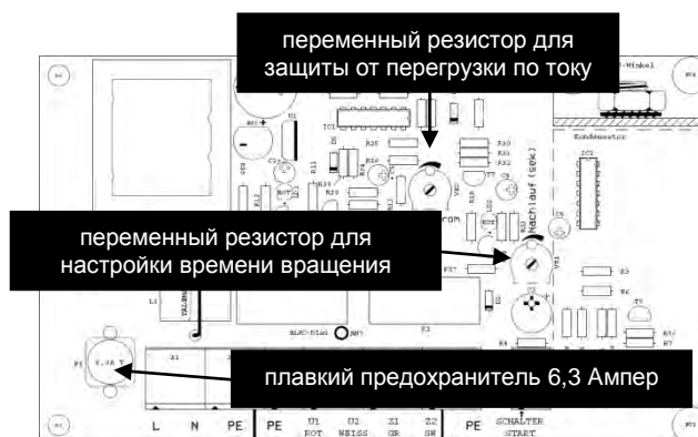
Рис. 5: Схема распределительной коробки
