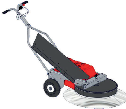
(Abb. 20 - Schwadblech einschieben)
