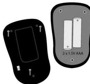
**WARNUNG!** Nicht wiederaufladen! Versuche, die Batterie erneut aufzuladen, können zu einer Zerstörung oder einem Austreten von gefährlichen Flüssigkeiten, die eine Korrosion der Ausrüstung verursachen, führen.
